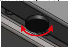
Figura 4. Nivelación del dispositivo
