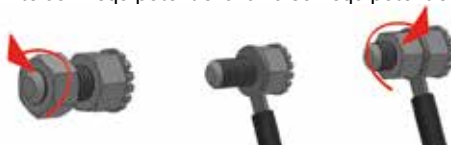
Fig. 5. Raccordement de l'appareil à une installation équipotentielle.
