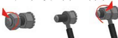
Rys. 5. Podłączenie urządzenia do instalacji wyrównującej potencjały elektryczne.
