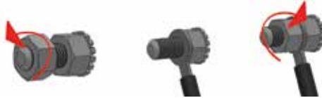
Figura 5. Conexión del equipo a una instalación equipotencial.
