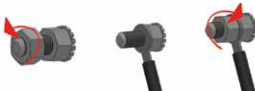
Figure 10. Branchement de l'appareil au dispositif équipotentiel
