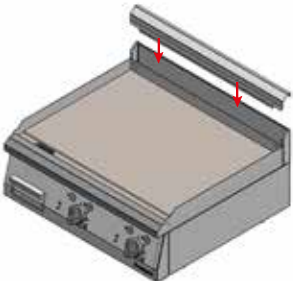
Rysunek 12. Montaż osłony kominka.
