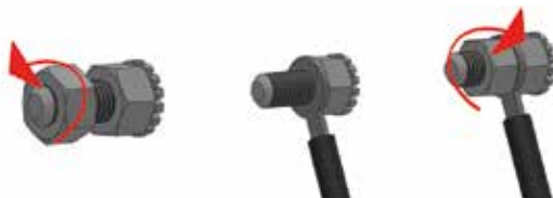
Figura 10. Conexión del equipo a una instalación equipotencial.
