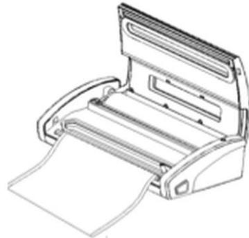
9. Legen Sie anschließend ein offenes Ende des abgeschnittenen Vakuumier-Beutels über den Schweißbalken des Gerätes, aber nicht bis in die Vakuumkammer.
