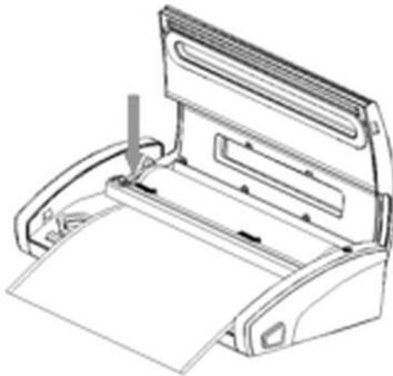
8. Schieben Sie das Messer von einem Ende zum anderen Ende, um mit einem genauen und sauberen Schnitt einen Vakuumier-Beutel zuzuschneiden.
