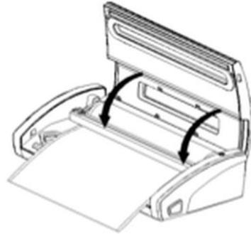
7. Ziehen Sie die Schneidevorrichtung herunter und legen Sie diese über die Folirolle.
